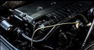
Motor Mercedes-Benz OM924 Euro V de 4 cilindros, con 154 hp, y un torque de 428 libras, pie de 1,200 a 1,600 RPM.
